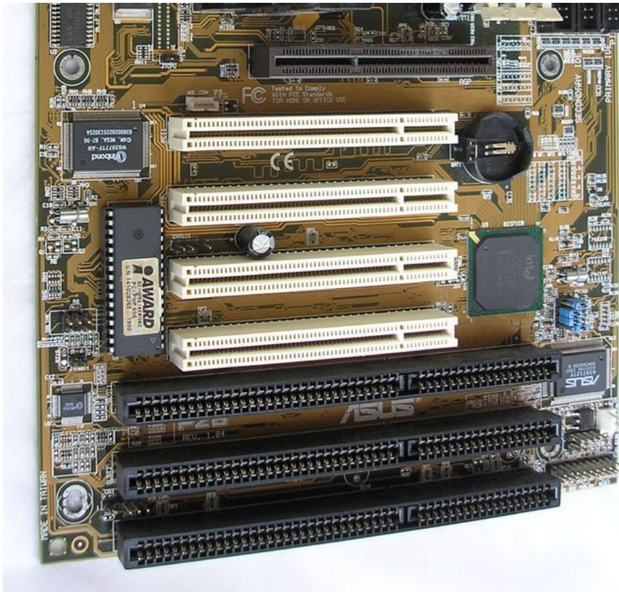
166. Slika: Slotovi jedne starije matične ploče: jedan AGP slot (braon, sa gornje strane), četiri PCI slota (beli, na sredini) i tri ISA slota (crni, sa donje strane)
