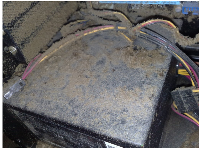
285. Slika: Sloj prašine na napajanju
