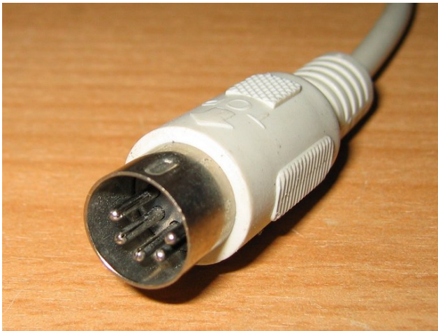
219. Slika: 5-pinski DIN utikač...
