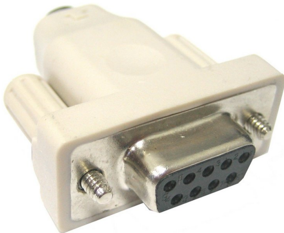
227. Slika: Serijski utikač (tip DB-9 sa 9 pina)...
