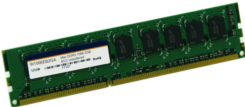
36. Slika: RAM memorija, u ovom slučaju DDR3
