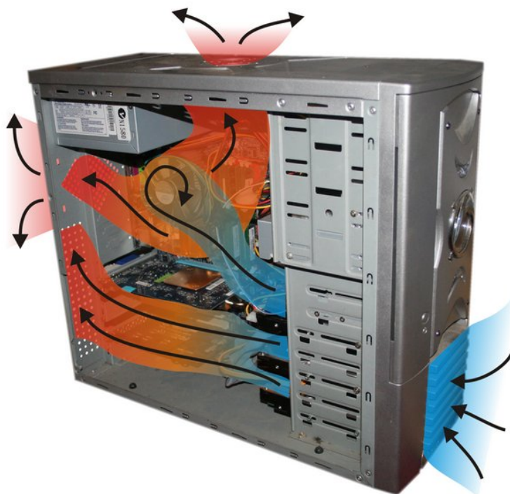
136. Slika: Dobra ventilacija kućišta podrazumeva bar jedan uduvni i izduvni ventilator
