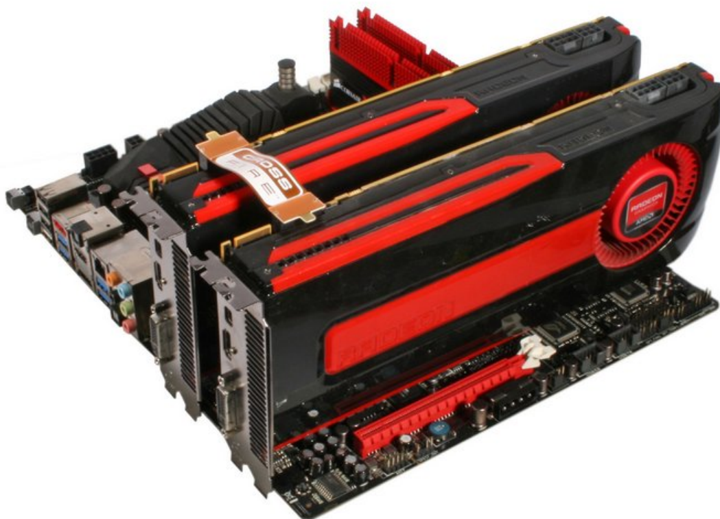
263. Slika: Povezivanje dve grafičke kartice pomoću mosta omogućava direktnu vezu između povezanih kartica
