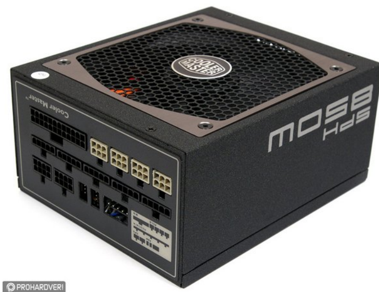
144. Slika: Modularno napajanje omogućava skidanje nepotrebnih kablova. Na slici jedno skroz modularno napajanje
