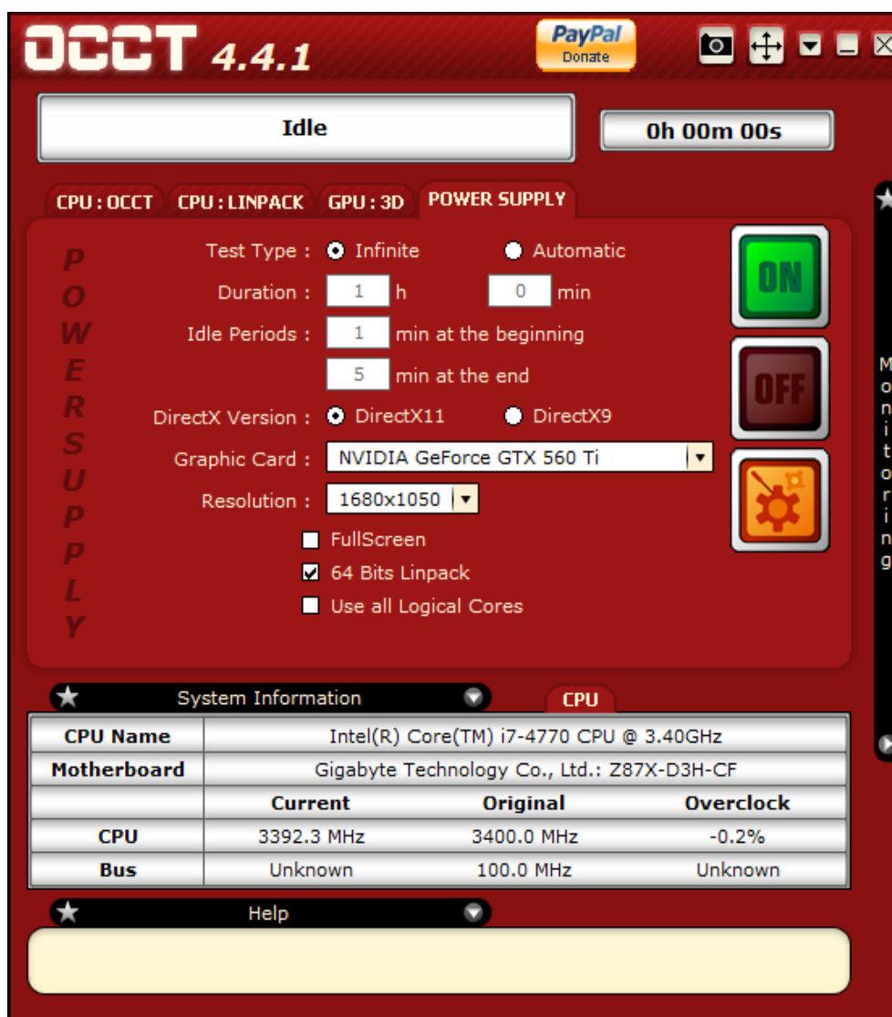
319. Slika: Korisnički interfejs programa OCCT. Na slici podešavanje parametara za testiranje napajanja.
