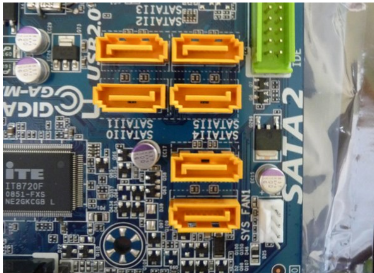
155. Slika: SATA konektori. Primećujemo da imaju oblik slova „L“.
