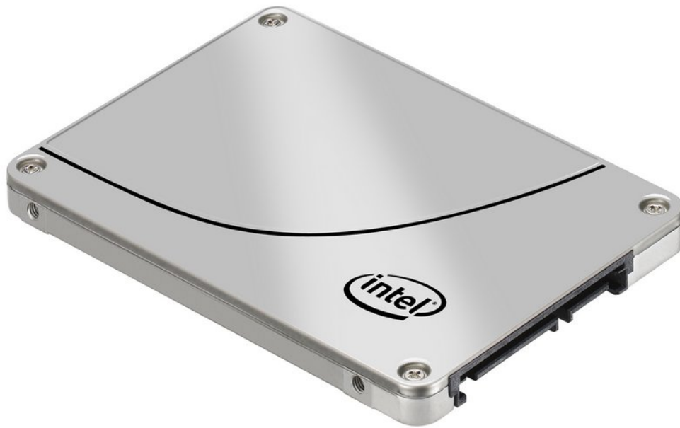
212. Slika: Kao što se može videti, SSD uređaji sa spolja jako liče na hard diskove...
