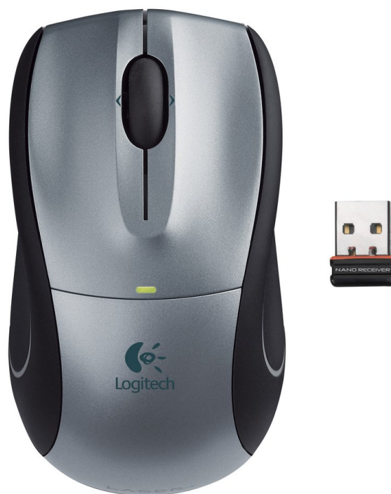
230. Slika: Bežični miš sa malim primopredajnikom
