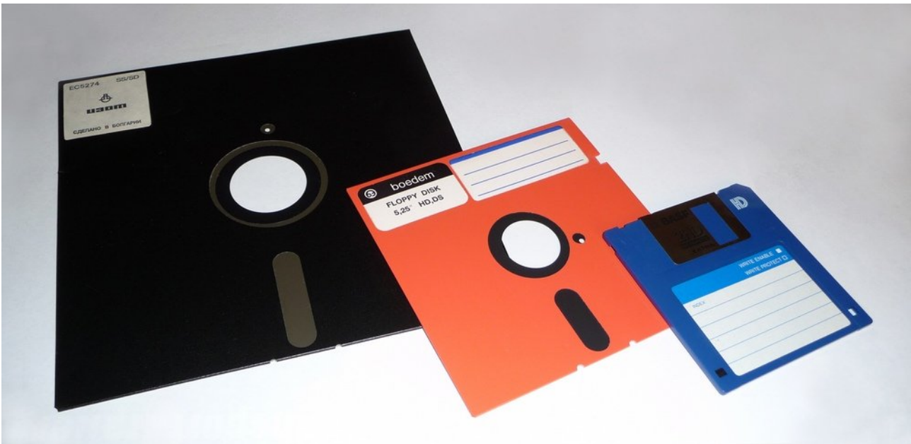
37. Slika: Razne floppy diskete. Zanimljivo je da je najveća varijanta imala najmanji kapacitet, a najmanja varijanta – najveći.
